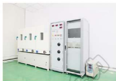
图八 1000h115°C老化试验装置
