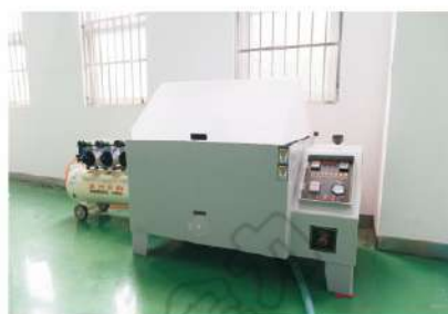
图七 900mm全自动盐雾试验箱
