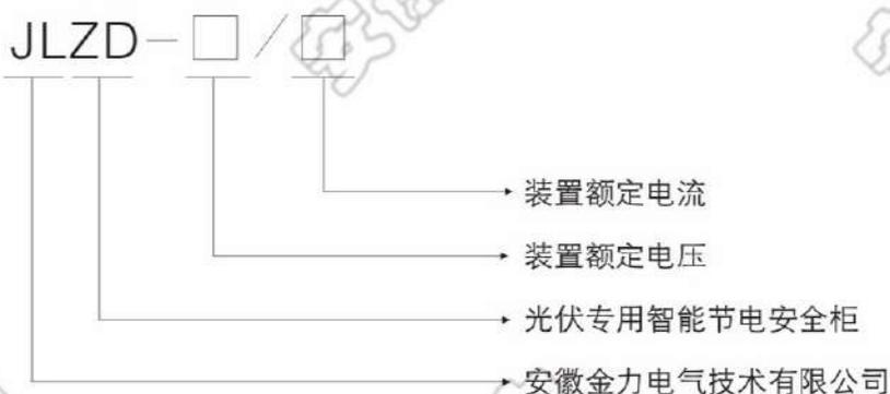
装置额定电压 (kV)：12、40.5
